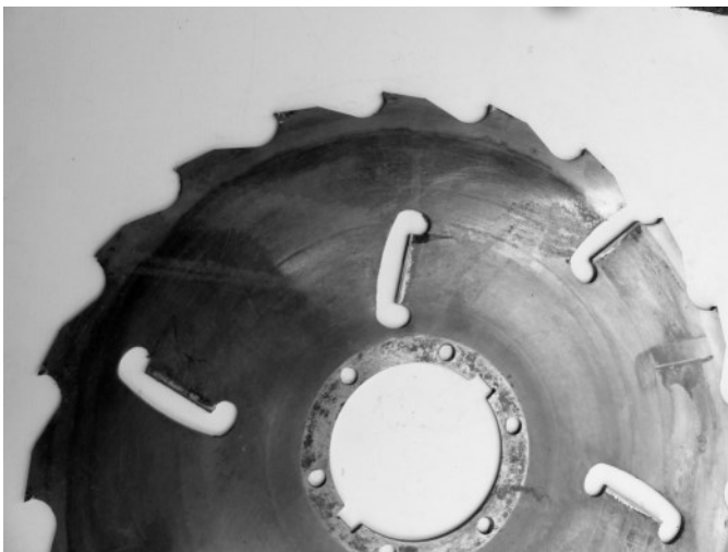
Exemple de lame de scie à dents rapportées : à proscrire !
