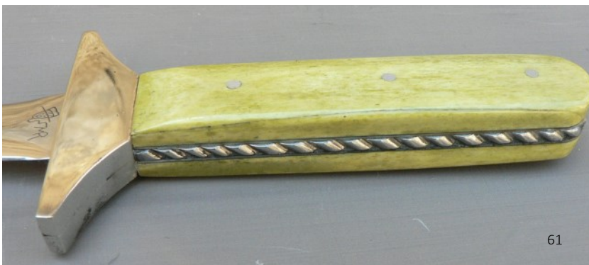
Os de chameau teinté pour les plaquettes de cette dague de botte à plate-semelle cordée. (Figure dans le livre des 20 ans de Mercorne p. 165; offert à Mercorne)
