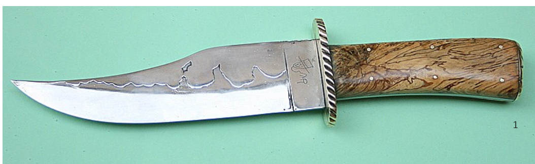
Le manche de ce Bowie est en chêne vert attaqué par un champignon lignicole et stabilisé.
