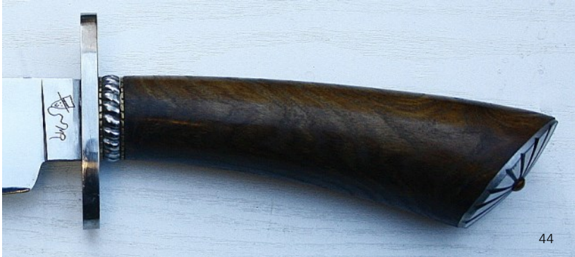
Bowie de chasse dont la garde, la bague et le pommeau sont en fer fourbi.
