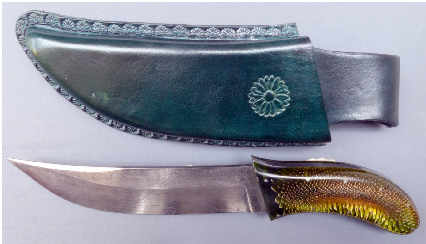
n° 396 Grand couteau de 29,5 cm, lame en damas de 17 cm émoulue par J. Domingo, plaquettes tirées d'un capitule de cardère stabilisé par Mercorne étui en cuir à décor floral
