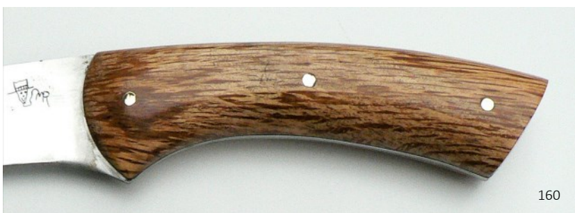
Plaquettes plein manche en chêne vert pour ce couteau de chasse à plate-semelle .
