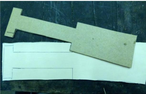
La pièce du dos sera tracée sur le cuir (attention à ne pas se tromper de côté!) à l'aide d'un gabarit ad-hoc en carton. Deux fentes parallèles de 20 x4 mm seront pratiquées à l'endroit voulu pour faire passer le collier d'attache du manche.
