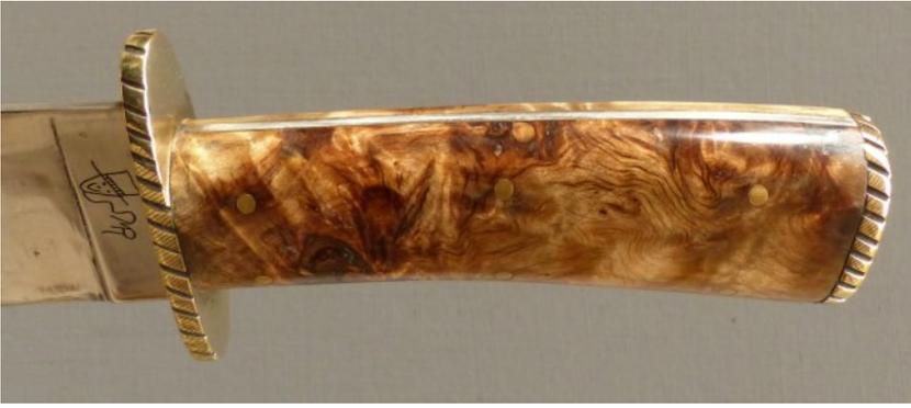
Le montage à plate-semelle n'empêche pas la pose d'un pommeau : celui-ci est fixé par des goujons collés dans le bois des plaquettes. Le manche de ce grand Bowie est en loupe de peuplier stabilisée.
