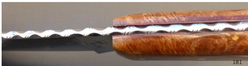
Guillochage d'aspect végétal sur le dos de la lame et de la plate-semelle de ce couteau à plaquettes en chêne vert échauffé.
