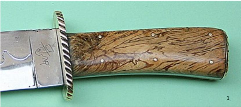
Chêne vert échauffé et stabilisé pour le manche de ce Bowie à plate-semelle .
