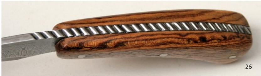
Dos de plate-semelle cordé sur une lame en damas avec plaquettes de bocote.
