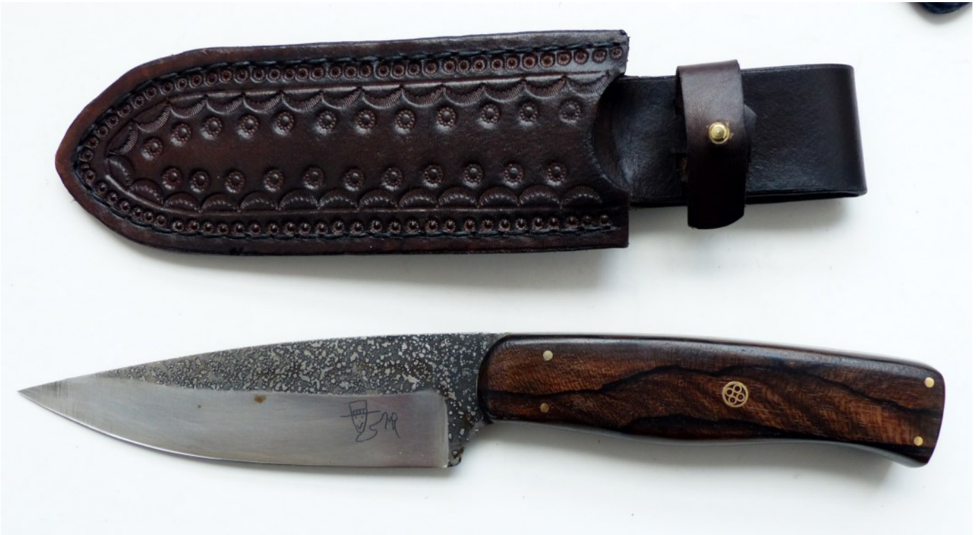
N° 484 couteau de chasse de 23 cm lame de 12 cm, structurée à l'eau forte émoulue par j. Domingo, plaquettes en ziricote décorées d'un rivet étui assorti en cuir
