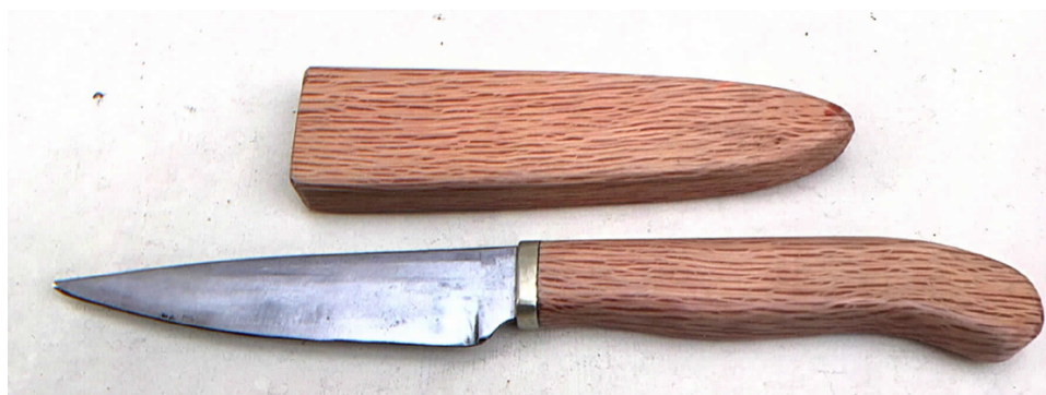
N° 578 : A partir d'une lame faite par Vincent Meyrueix, ce couteau a été monté avec une bague en maillechort, une poignée et un étui en chêne vert.
