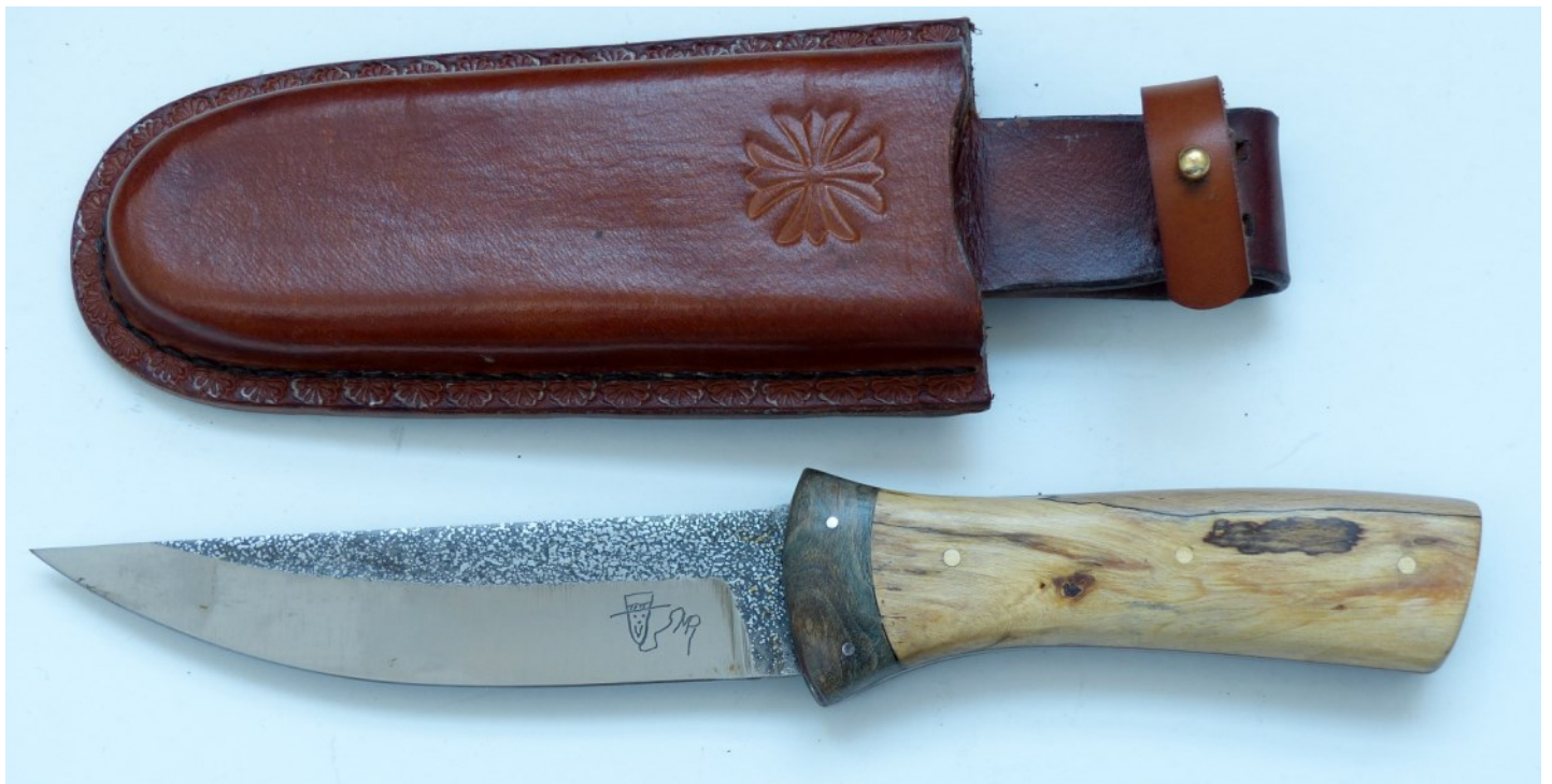
n° 467 couteau de chasse de 26 cm, lame de 13,5 cm, structurée à l'eau forte, émoulue par J. Domingo, mitres arrondies en loupe de peuplier stabilisée et colorée, plaquettes en hêtre stabilisé étui en cuir à décor occitan
