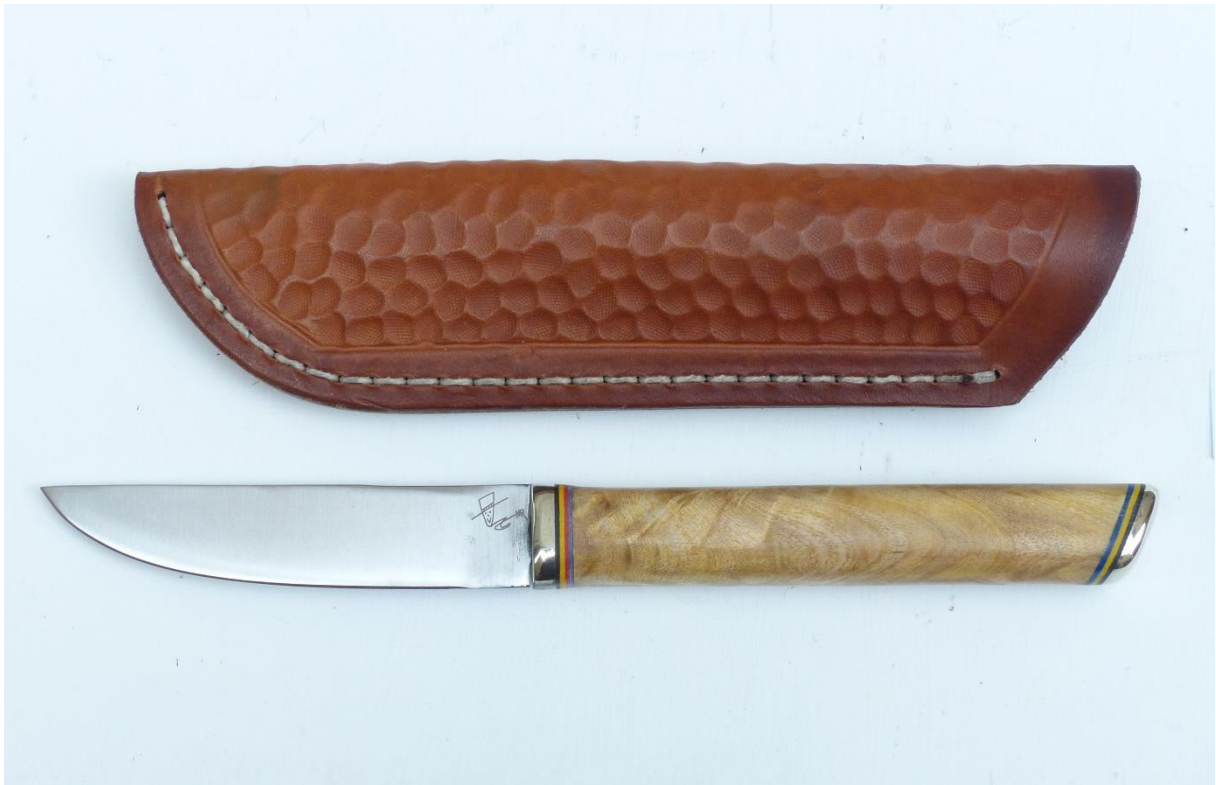
N° 693 Couteau de 21,5 cm, lame en acier inox de 9,5 cm ; garde et pommeau en maillechort ; poignée en fourche de peuplier stabilisée ; étui cousu en cuir frappé.
