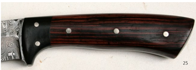
Fort couteau à épaisse lame en damas. Les mitres sont en ébène, les plaquettes en cocobolo.
