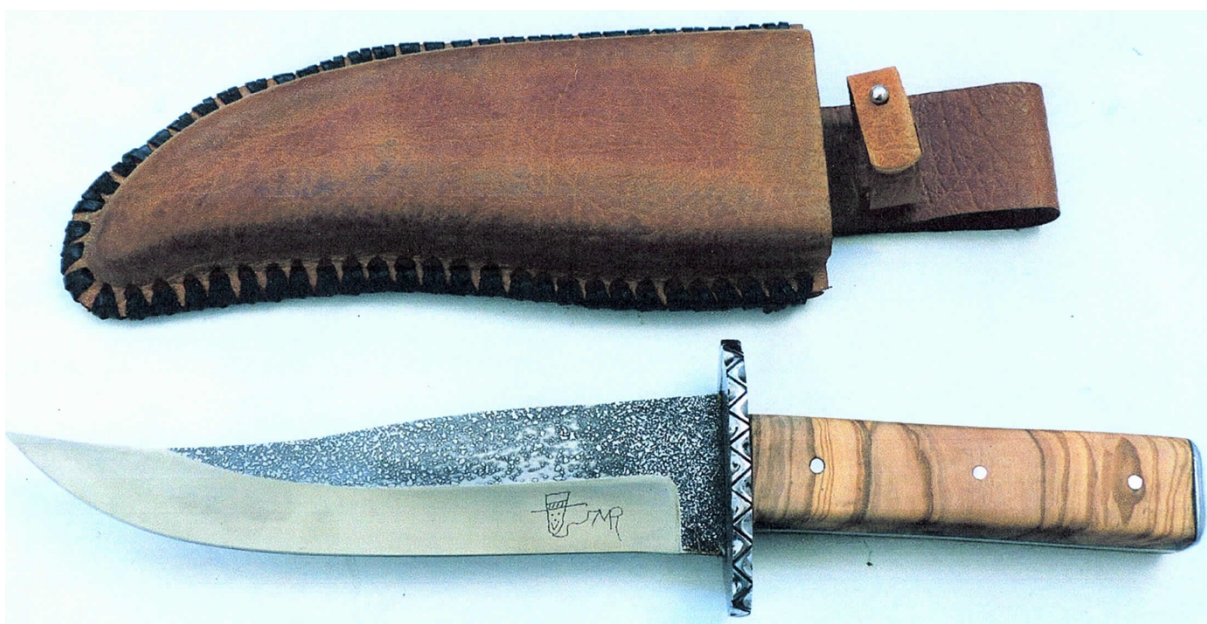
N° 542 : Bowie de chasse de 31,5 cm, lame de 19 cm, structurée à l'eau forte, émoulue par J. Domingo, double garde guillochée et pommeau en fer fourbi, plaquettes en frêne (bois de travers), étui lacé en cuir.
