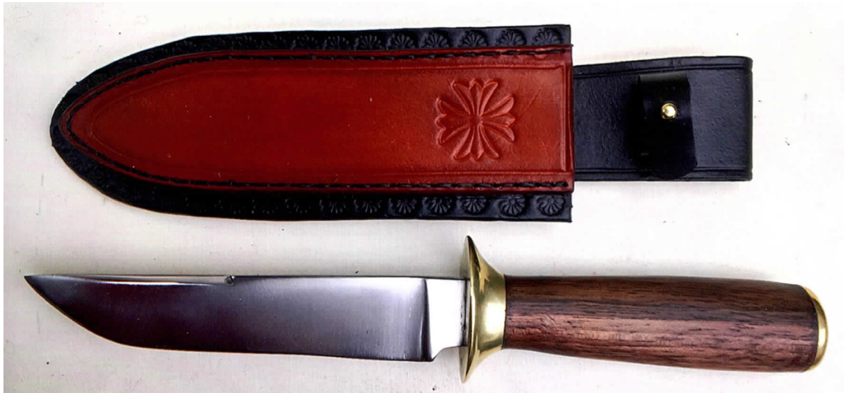
N° 575 : Couteau de chasse de 25cm, lame en inox de 13,5cm. Cette lame provient d'un couteau qui existait à Venède. J'ai dû meuler la marque. La garde et le pommeau sont en laiton fondu par Armel Crespi. Poignée en noyer. Étui en cuir bicolore décoré.
