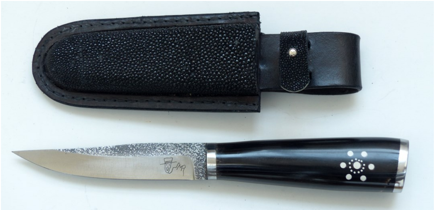
n° 464 utilitaire 22,5 cm, lame de 11,5 cm, structurée à l'eau forte, émoulue par J. Domingo, bague et pommeau en fer fourbu, poignée pleine corne noire décorée par pointillisme, étui assorti en galuchat
