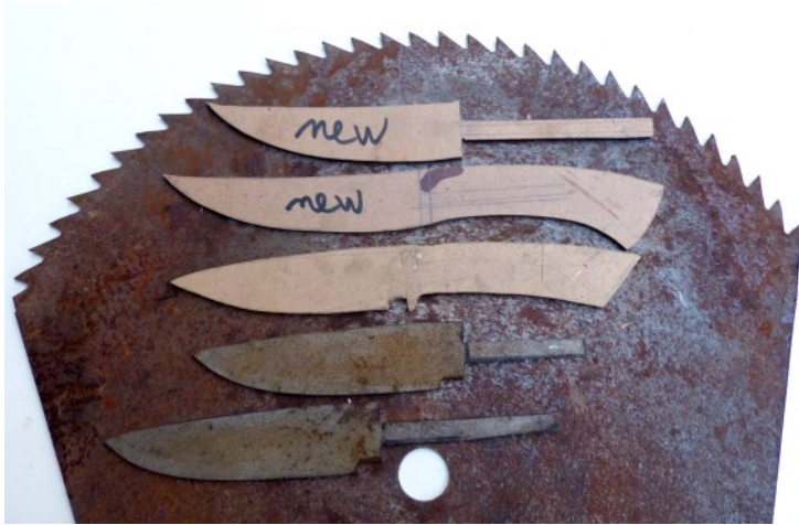
Gabarits en carton et lames prêtes pour l'émouture posés sur une portion de scie circulaire
