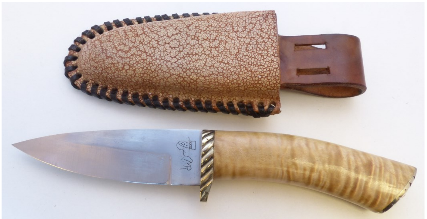
297 Couteau de chasse monté sur soie 22,5 cm lame 10,5 cm à émouture creuse (par J. Domingo), demi-garde et talon cordés en maillechort, poignée en peuplier ondé et stabilisé (du mas Lombard) étui lacé en galuchat poncé assorti
