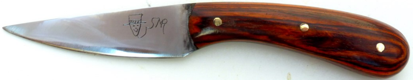
292 Couteau de ceinture en remplacement de celui que j'ai porté plusieurs années dont l'étui a été conservé 19 cm, lame 9 cm, plaquettes en cocobolo
