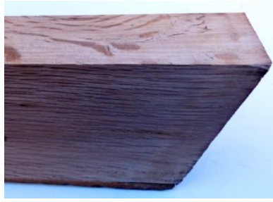
Coupes radiale et tangentielle sur un même bloc de chêne vert
