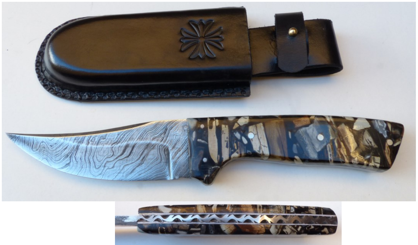
n° 424 Couteau de chasse de 23 cm, lame en damas de 10,5 cm émoulue par J. Domingo dos de la plate semelle guilloché, plaquettes plein manche en résine ivoire de mammoth étui en cuir à décor occitan
