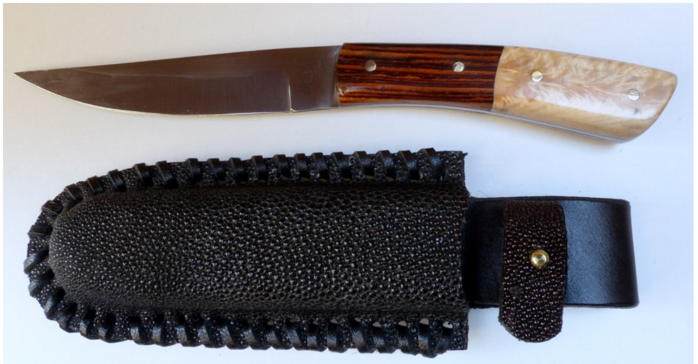
322 Couteau sans garde de 23,5 cm, lame de 12 cm, émouture J. Domingo, longues mitres en cocobolo, courtes plaquettes en fourches de peuplier stabilisées étui lacé en galuchat
