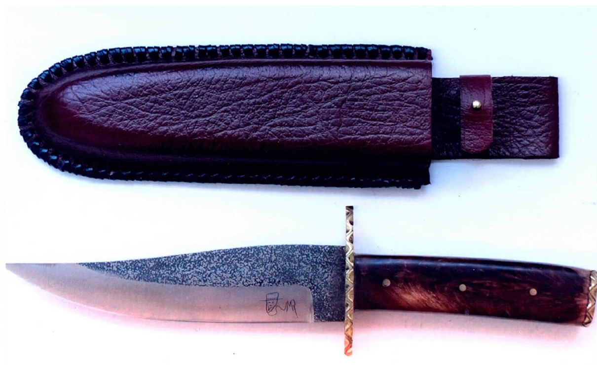
N° 548 : Couteau de chasse de 32 cm. Lame de 18,5cm émoulue par J. Domingo (plate semelle). Double garde et pommeau en laiton, guillochés. Plaquettes en cerisier stabilisé. Étui lacé en cuir structuré.
