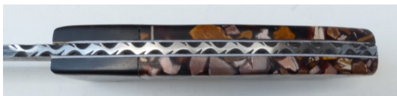
n° 435 couteau de chasse de 27,5 cm, lame en damas de 14,5 cm, émoulue par J. Domingo avec un contre tranchant, sans ricasso, dos de la plate semelle guilloché, mitres en ébène, plaquettes en nougatine Mercorne (agglomérat d'ivoire de mammouth), étui en cuir à double attache à décor occitan.
