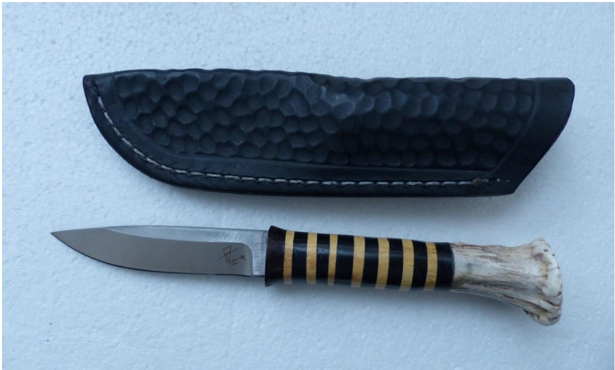
N° 679 Couteau de stype Scagel de 20 cm, lame de 9 cm émoulue par J. Domingo, bague en cocobolo, poignée faite d'une alternance de bagues d'ébène et de buis terminée pour un rondin de bois de chevreuil avec meule ; étui cousu en cuir frappé.
