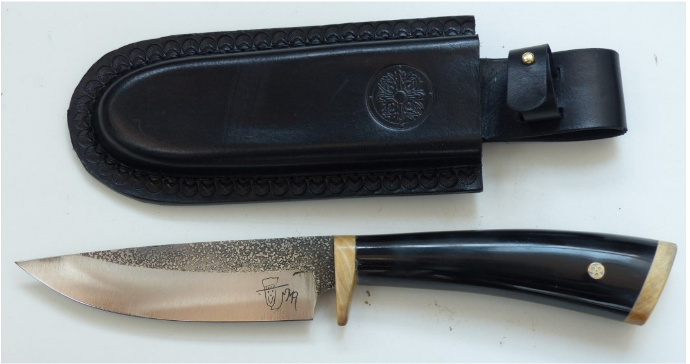
n° 468 couteau de chasse de 25,5cm, lame de 12,5 cm, structurée à l'eau forte, émoulue par J. Domingo, demi garde et talon en peuplier stabilisé, poignée pleine corne décorée d'un rivet étui en cuir à décor floral
