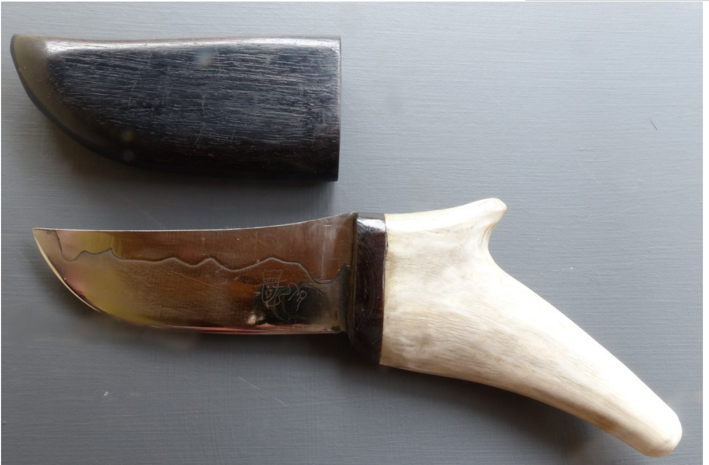
n° 356 Couteau à écorcher de 22 cm, lame de 11 cm structurée à l'eau forte, bague en cytise, poignée pistolet en bois de cerf blanchi étui en noyer teinté en noir
