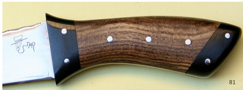
Plaquettes en sophora stabilisé pour ces couteaux de chasse dont les doubles mitres sont en cocobolo pour l'un, en ébène pour l'autre.
