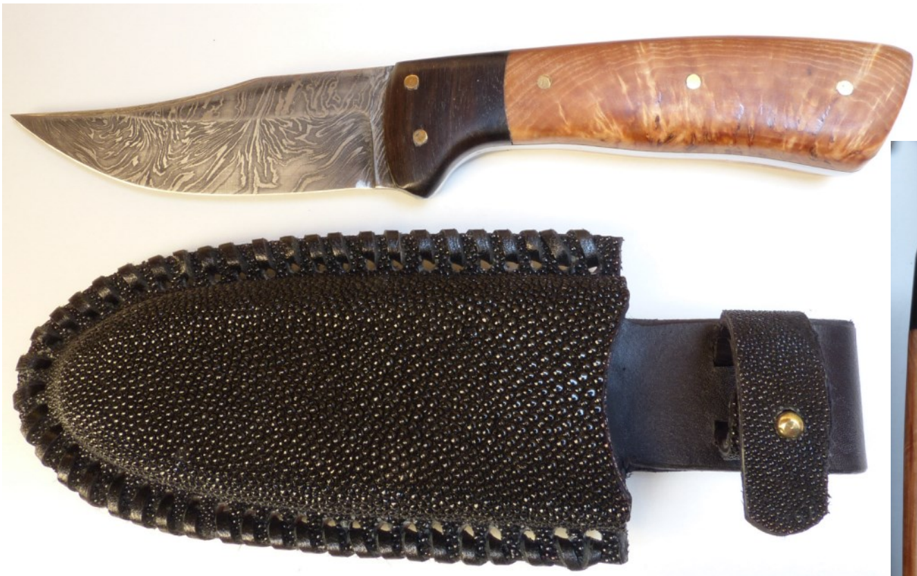
320 Fort couteau de chasse, 23 cm, lame en Damas de 10,5 cm, émouture J. Domingo, dos de la plate-semelle guilloché, mitres en ébène, plaquettes en loupe de peuplier en bois de bout stabilisée étui lacé en galuchat
