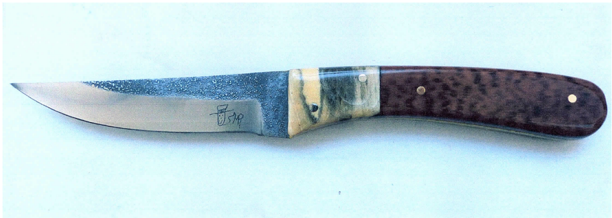
N° 536 : Couteau de table 23 cm, lame de 12 cm structurée à l'eau forte et émoulue par J. Domingo, mitres en marronnier stabilisé du mas Lombard, plaquettes en amourette.
