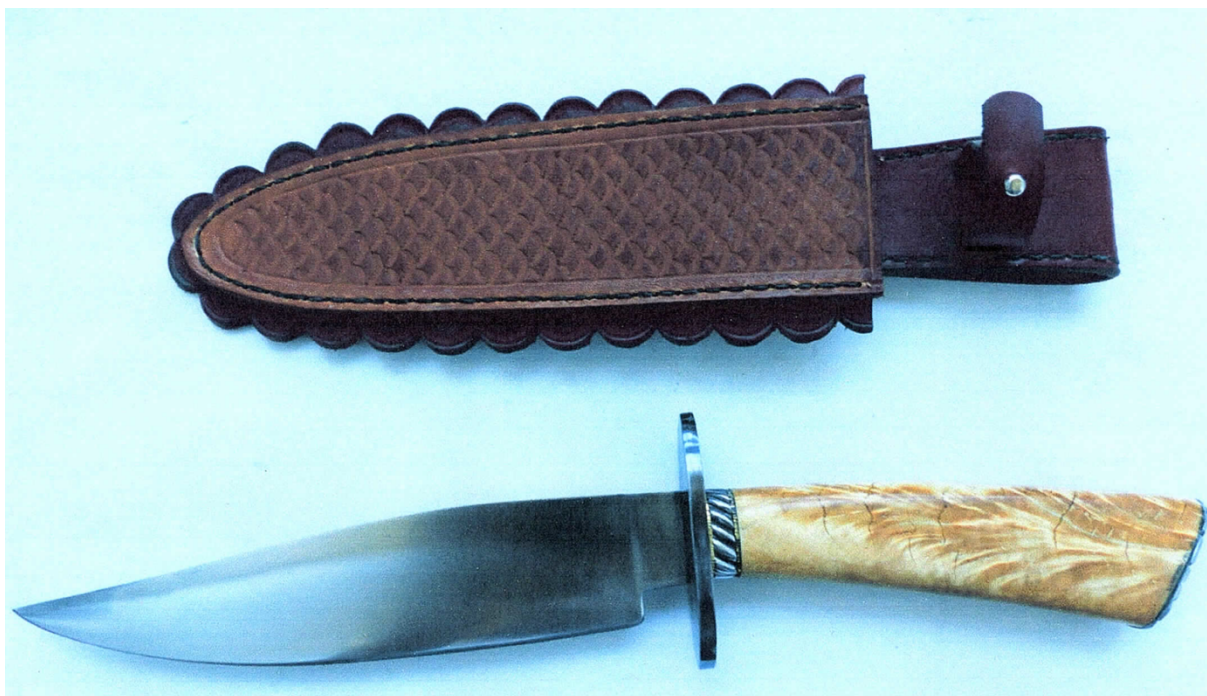
N° 541 : Bowie de chasse de 33,5 cm, lame de 19 cm émoulue par J. Domingo (émouture plate) double garde en fer bleui, bague 3 pièces cordée en fer fourbi, poignée en fourche.
