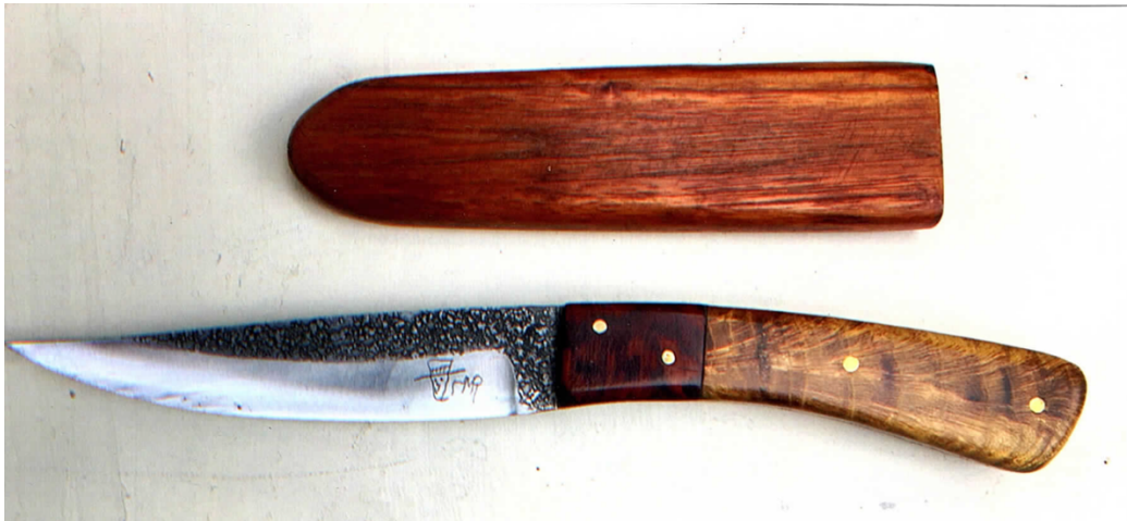
N° 558 : Couteau de table. Plaquettes en chêne (fourche) mitres en cocobolo, étui en cytise.
