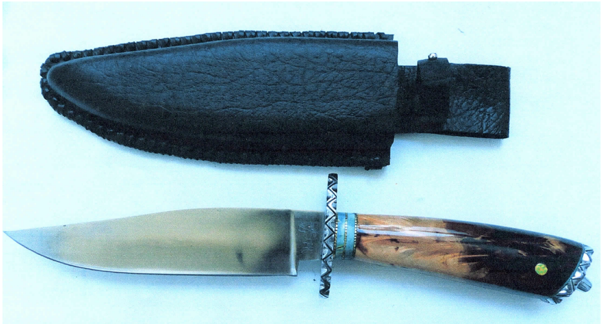
N° 539 : Bowie de chasse de 33,5 cm, lame de 18 cm émoulue par J. Domingo (émouture plate), double garde et pommeau vissé guillochés en fer fourbi, bague 5 pièces, poignée en fourche de peuplier stabilisée, décorée d'un rivet. Étui lacé en cuir.
